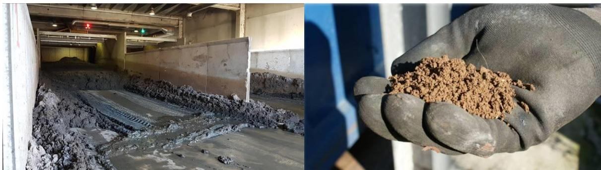
Slika 26. Komunalnog mulja nakon miješanja s vapnom i sumpornom kiselinom te gotovi poboljšivač tla, Agrosistemi (foto: I. Palčić; Agrosistemi)
