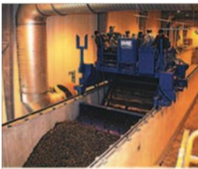
Slika 16. Linija za kompostiranje organskih sirovina u skladu sa sustavom ventiliranih dinamičkih rovova (Mondo Pulito).
